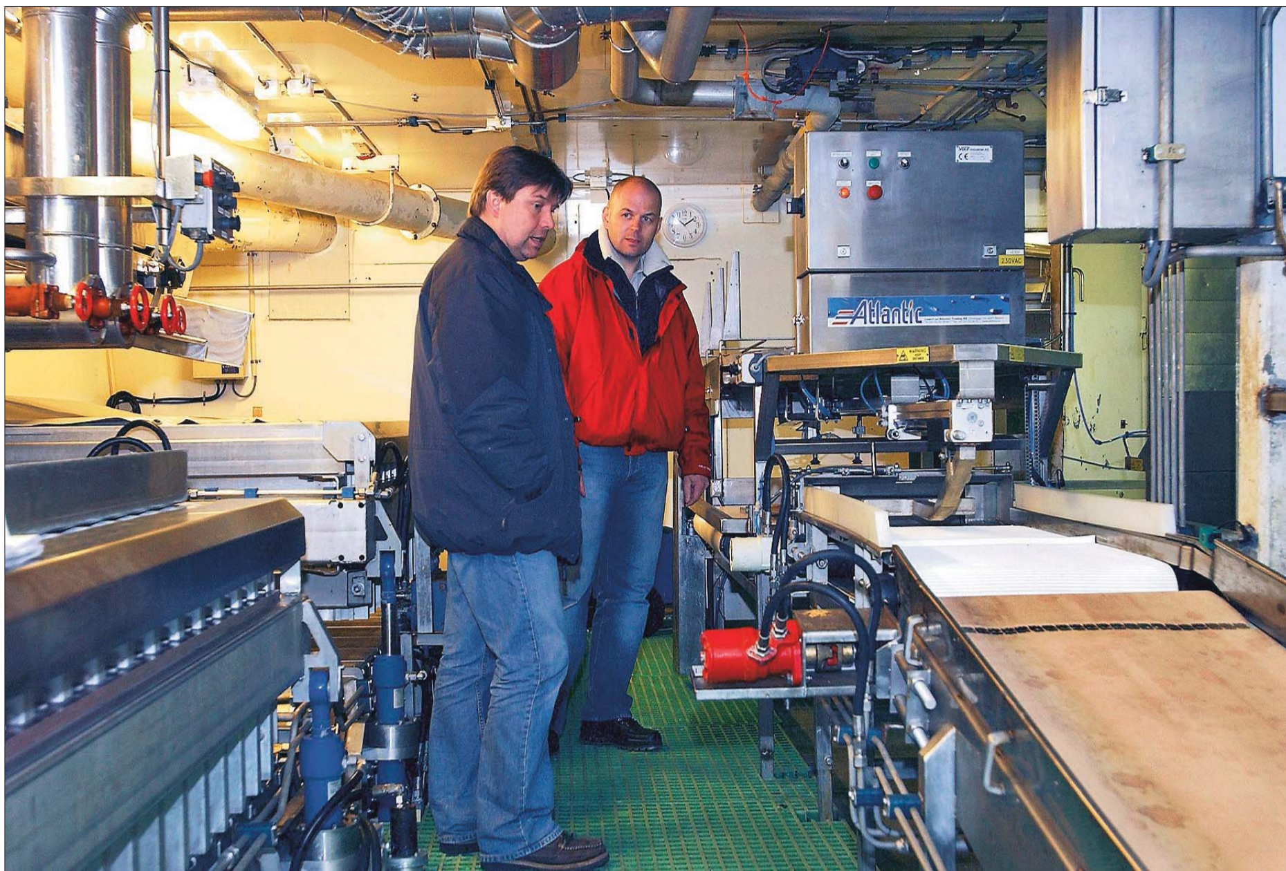
Teknisk sjef Erik Juelsen i Strand-rederiet (t.v) og Ove Godø i Atlantic framfor maskinen som pakker blokker med rundfrossen fisk i fabrikk på «Havbris».
